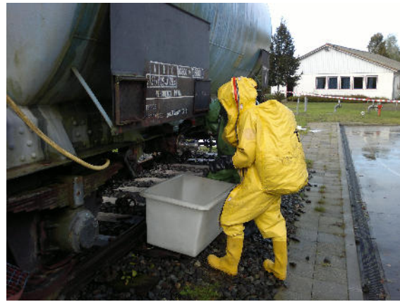
Abdichten eines Bodenventils am Kesselwagen
