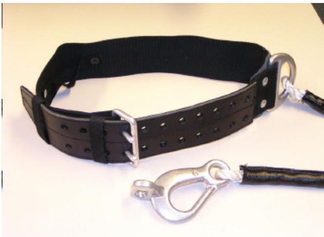
Die Feuerwehr-Haltegurte des Typ B erreichten die nach Norm vorgegebenen Prüfwerte - mit Ausnahme eines Gurtes – nicht. Bei den Haltegurten des Typs B handelt es sich um Gurte aus Polyester mit Zweidornschnalle. Im Bereich der Löcher für die Zweidornschnalle ist das Gurtmaterial mit Leder verstärkt.
